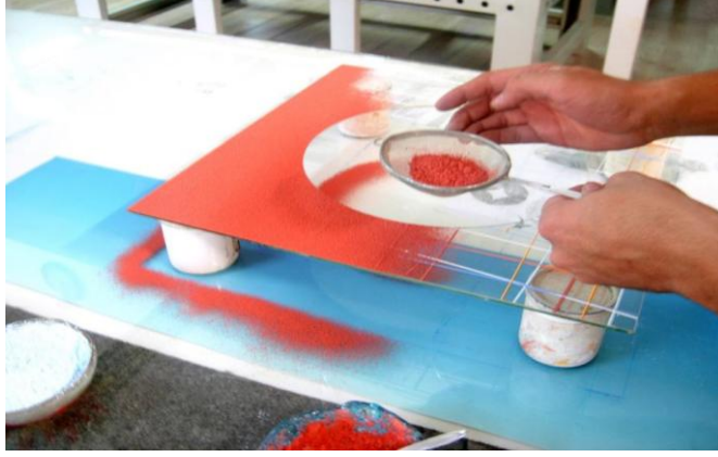
Resim 2.7: Eleme yöntemi ile boyama
