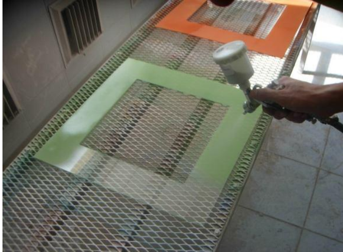
Resim 2.9: Püskürtme yöntemi ile boyama
